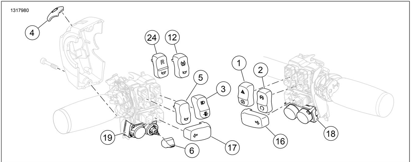
**Figura 3. Piezas de servicio para 71500186A: Tapas cromadas del interruptor del manillar**
