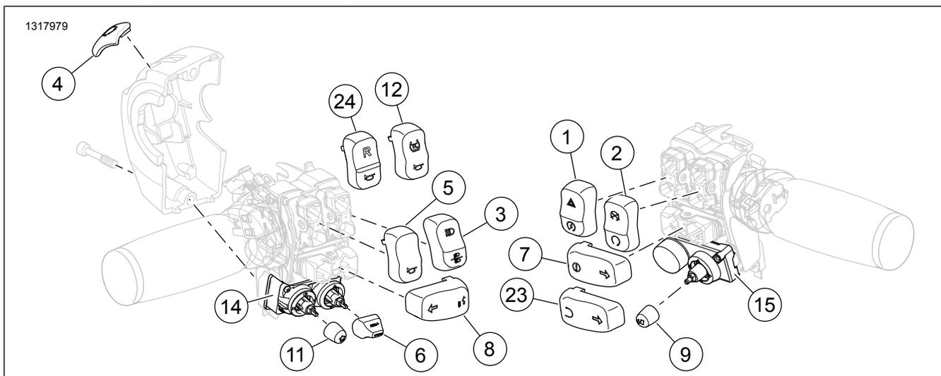
Figura 2. Piezas de servicio para 71500187C: Tapas cromadas del interruptor del manillar
