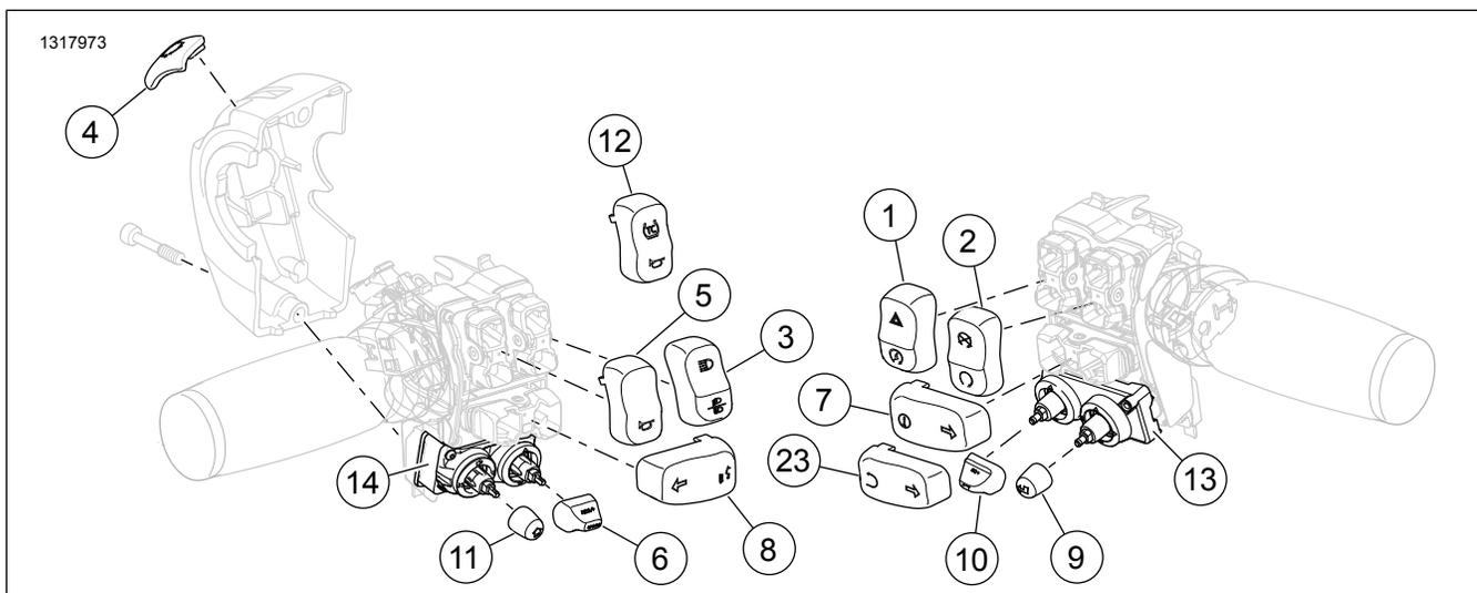
Figura 1. Piezas de servicio para 71500228C: Tapas cromadas del interruptor del manillar
