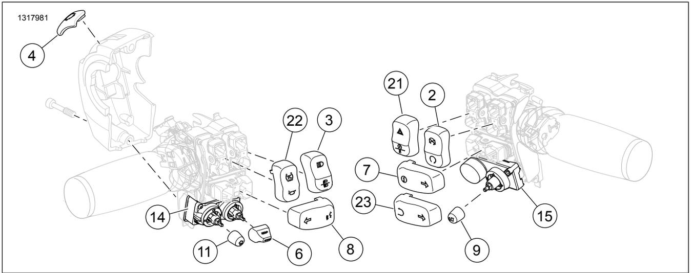
**Figura 4. Piezas de servicio para 71500515: Tapas cromadas del interruptor del manillar**
