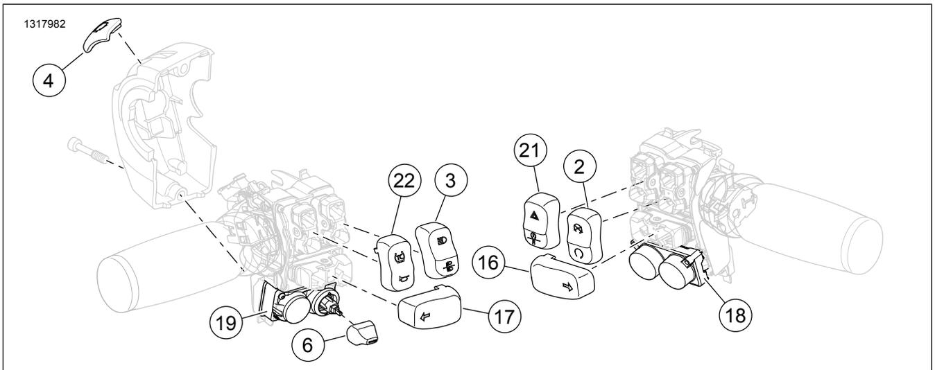
**Figura 5. Piezas de servicio para 71500517: Tapas cromadas del interruptor del manillar**
