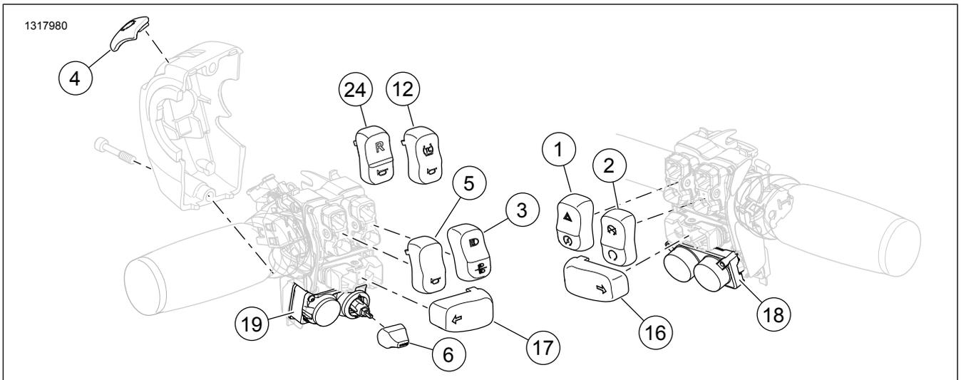
**Figura 3. Piezas de recambio para 71500186A: Tapas del interruptor del manillar cromadas**
