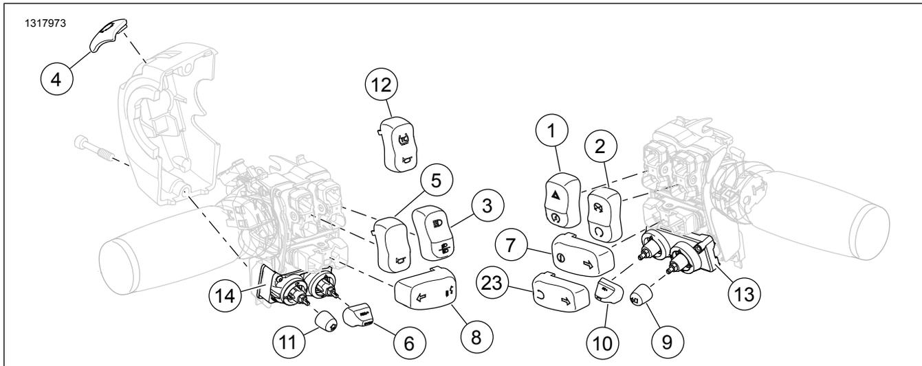
**Figura 1. Piezas de recambio para 71500228C: Tapas del interruptor del manillar cromadas**
