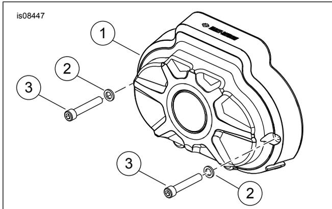
Figura 2. Tampa lateral da transmissão Burst (para o kit 3480026)
