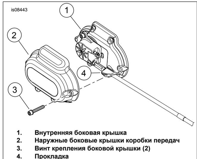
Рисунок 1. Боковые крышки коробки передач
