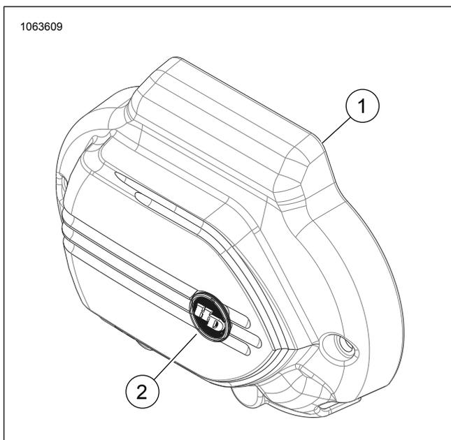
Рисунок 3. Боковая крышка коробки передач
