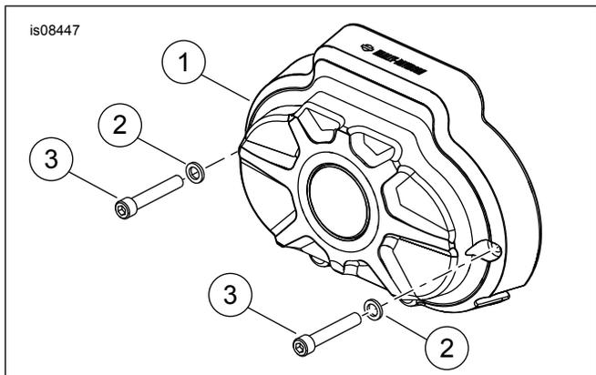
Рисунок 2. Боковая крышка коробки передач Burst (для комплекта 34800026)
