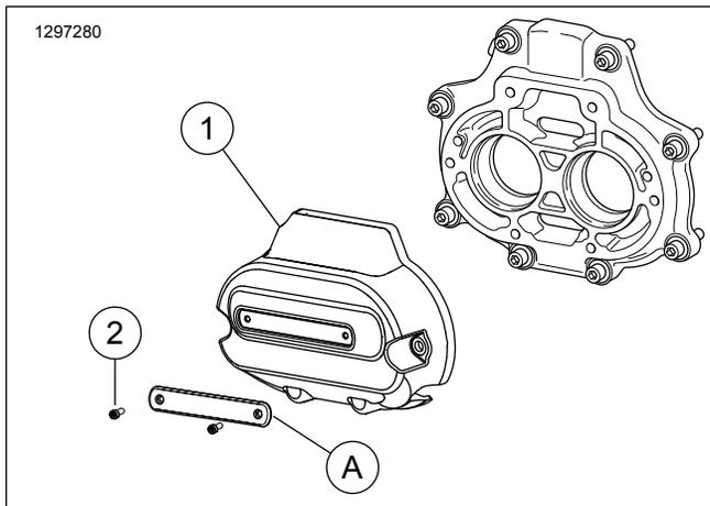
Рисунок 4. Боковая крышка коробки передач Dominion
