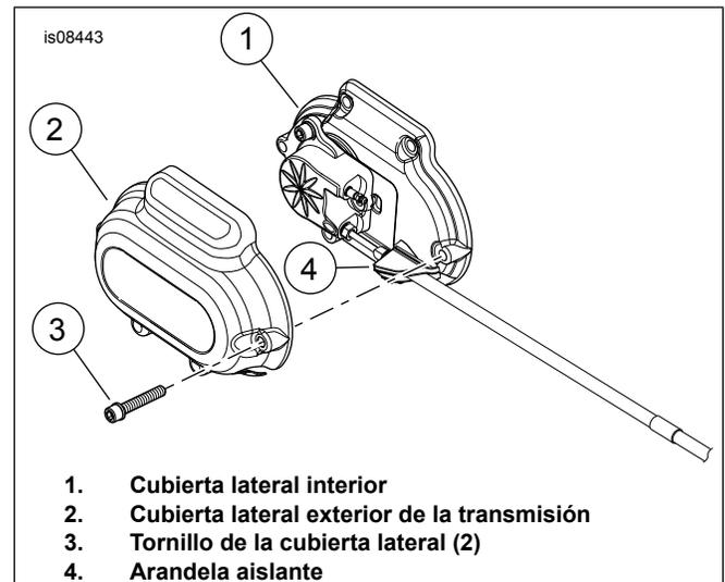
Figura 1. Cubiertas laterales de la transmisión
