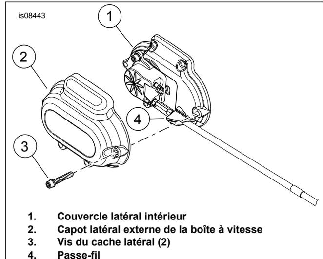
Figure 1. Caches latéraux de transmission
