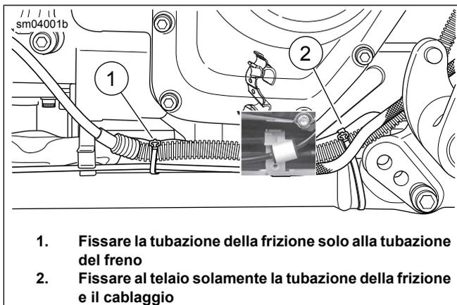
**Figura 2. Posizione della fascetta fermacavi della tubazione idraulica della frizione**
