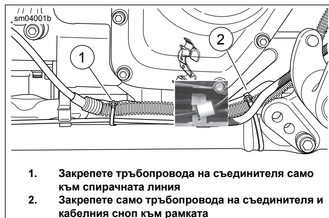
Фигура 2. Местоположение на кабелната връзка за тръбата за течност на съединителя
