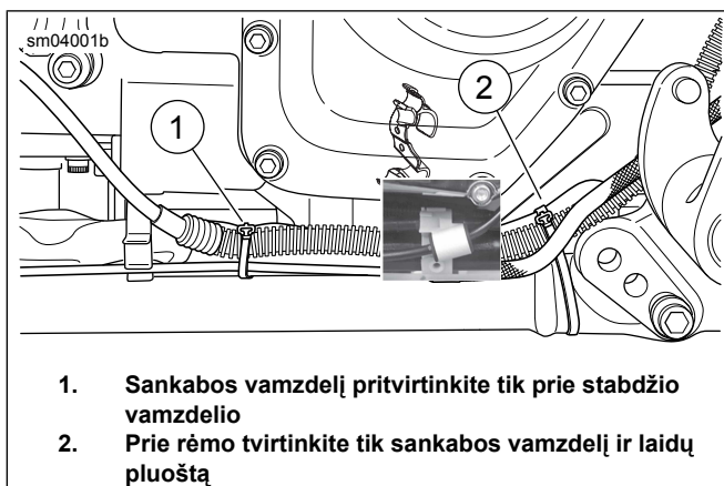
Pav 2. Sankabos skysčio linijos kabelio juostelės vieta
