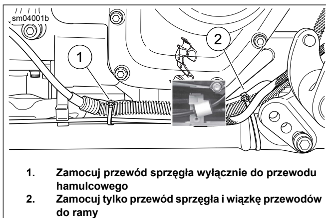
Rysunek 2. Położenie opasek kablowych przewodu płynu sprzęgła
