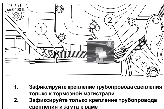
Рисунок 2. Расположение стяжки кабеля трубопровода жидкости гидропривода сцепления
