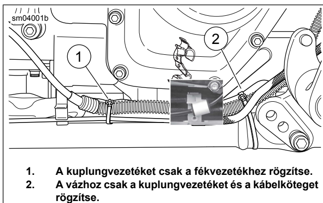
Ábra 2. A tengelykapcsoló-folyadék vezetéket rögzítő kábelkötegelő helye
