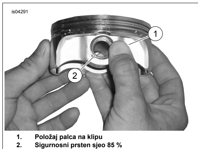
Slika 4. Postavljanje sigurnosnog prstena
