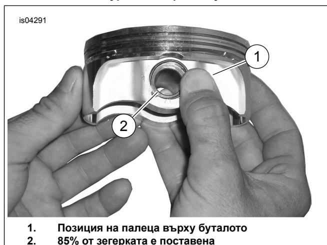
Фигура 4. Монтаж на зегерка
