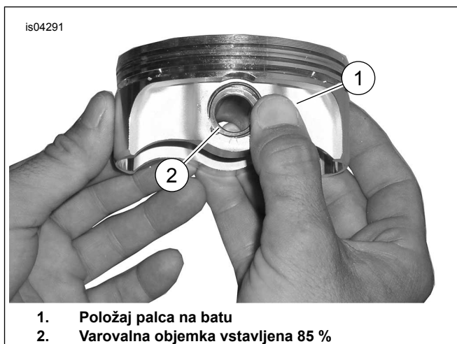
Slika 4. Namestitev varovalne objemke
