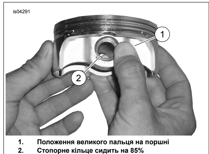
Малюнок 4. Установлення стопорного кільця
