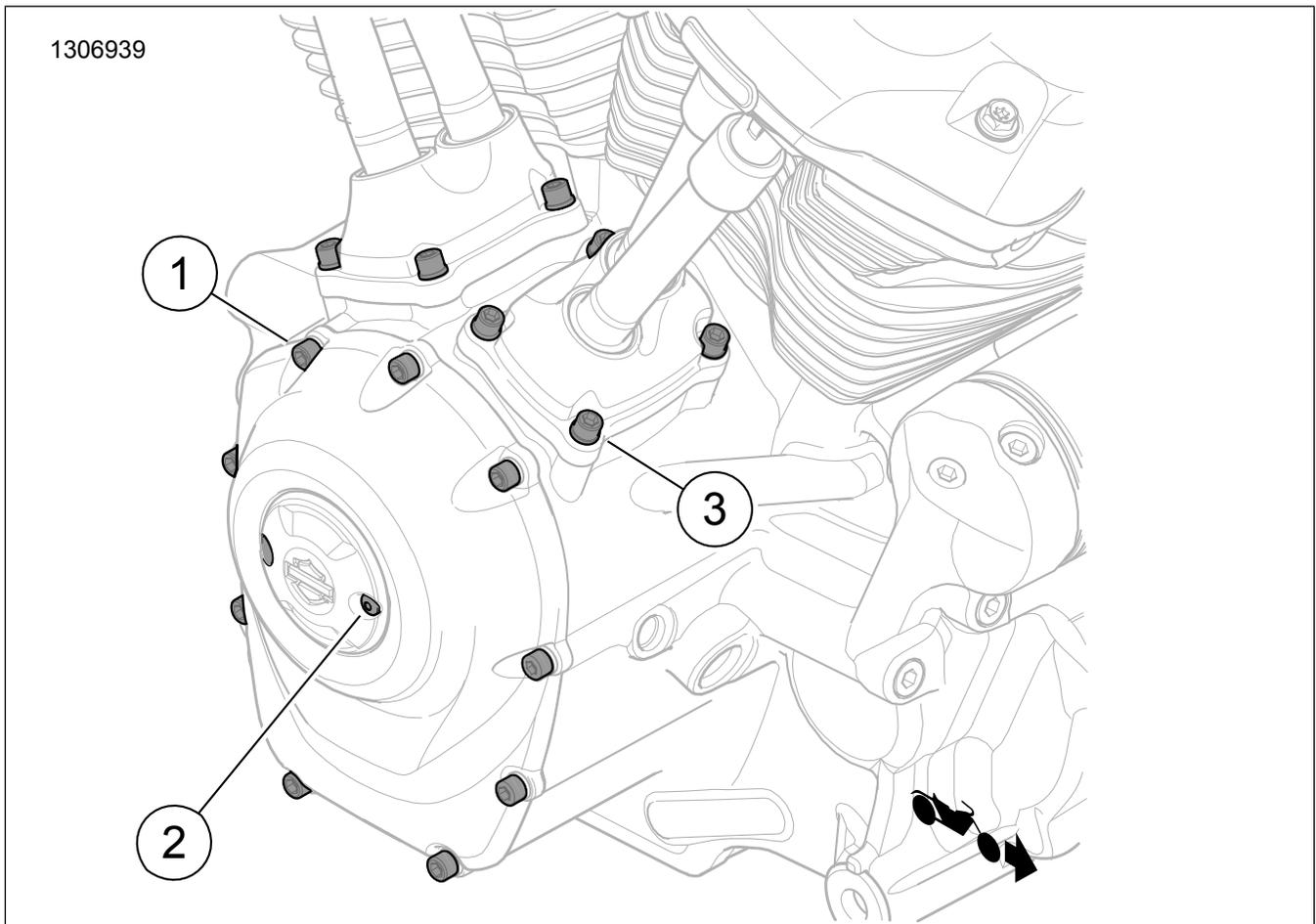
Figure 1. Contenu du kit : Composants du carter de distribution M8
