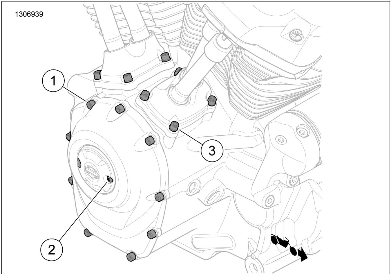
Figure 1. Contenu du kit : Composants du couvercle de cames M8
