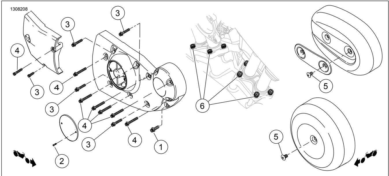
Figura 1. Contenido del kit: Componentes de la cubierta de levas XL
