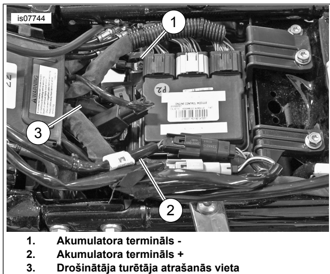
Attēls 11 Akumulatora savienojums
