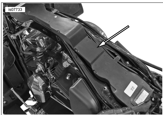
Figura 1. Canal de cabluri
