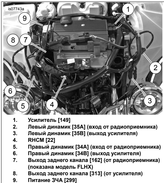
Рисунок 10. Соединения жгута проводов
