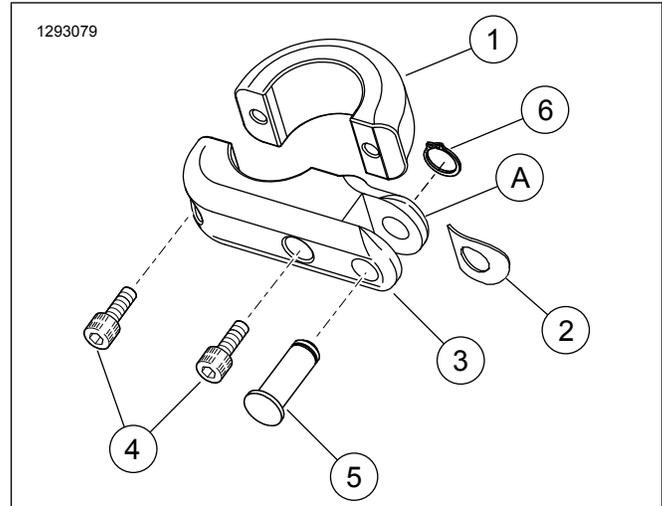
Figure 1. Pièces de rechange : Kit de montage de repose-pieds sur la barre de protection du moteur
