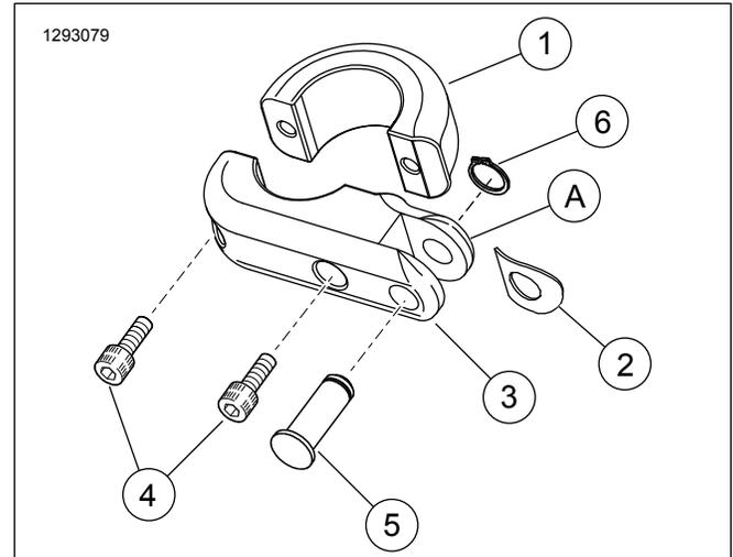
Figura 1. Peças de reposição: KIT DE MONTAGEM DO BOLETO DO PEDAL DE PROTEÇÃO DO MOTOR
