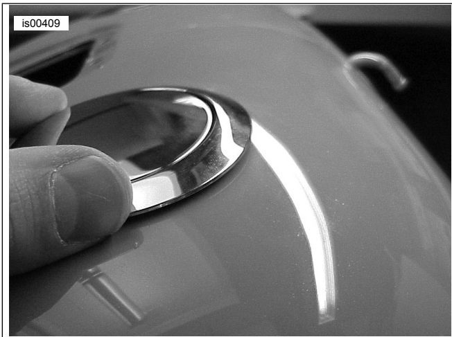
Figure 2. Déterminer la position de l'anneau de garniture
