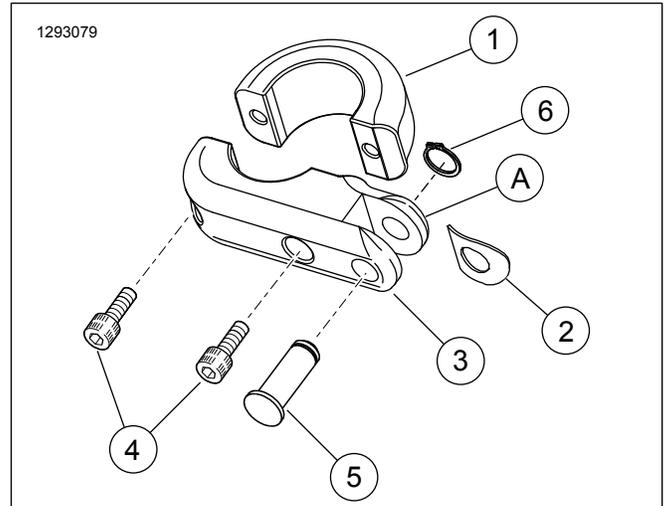
Figura 1. Piezas de servicio: Kit de montaje de taco apoyapiés estilo Billet en el protector del motor
