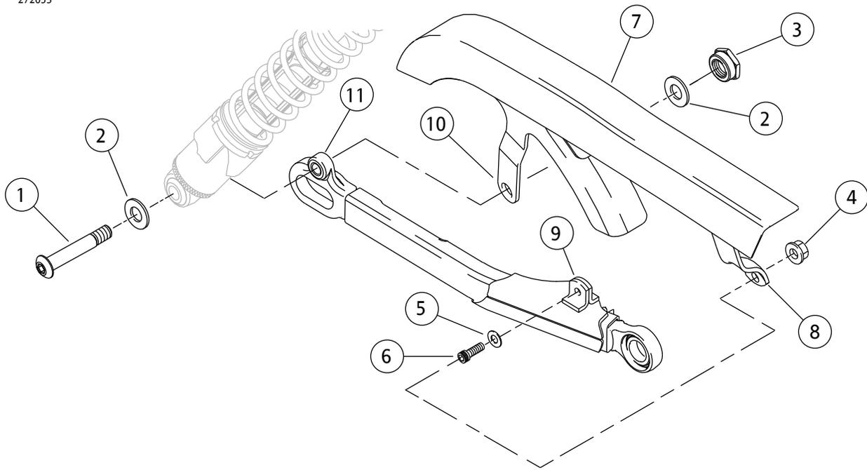
1. 下部减震器安装螺栓(右侧)
