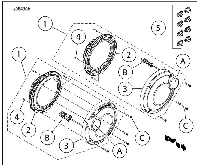
图2。维修零件：BOOM! Audio第II阶段后扬声器套件
