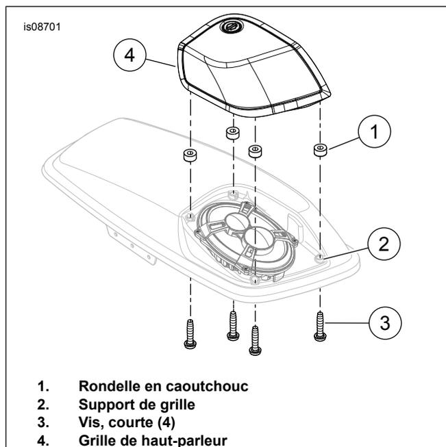
Figure 2. Installation de la grille
