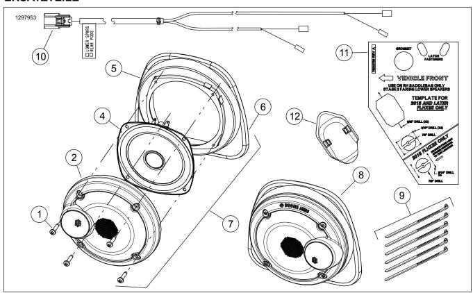
Abbildung 4. Ersatzteile, Lautsprecher für untere Verkleidung
