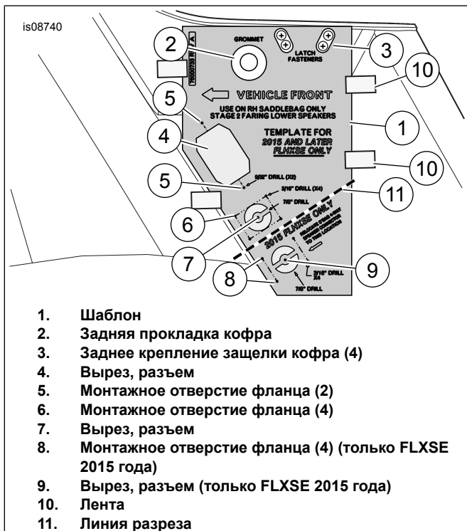
Рисунок 3. Разрез правого кофра и сверление, установка жгута
