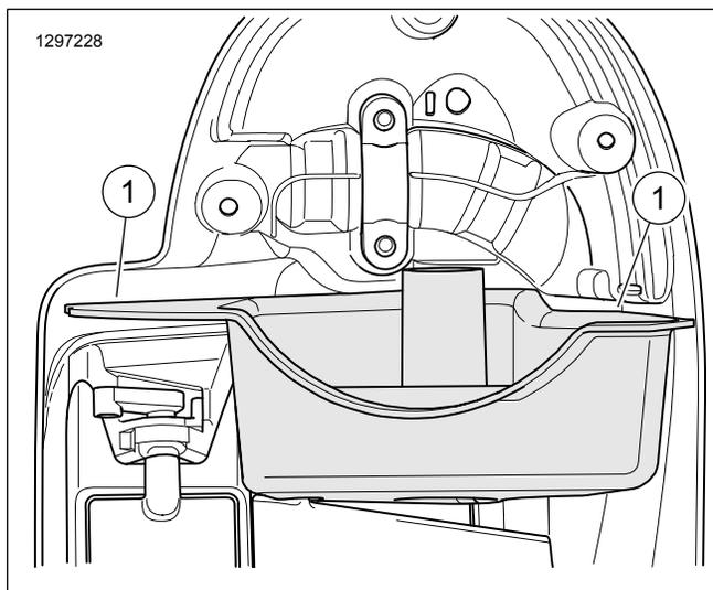
图5。下部挡风板的密封垫配合面
