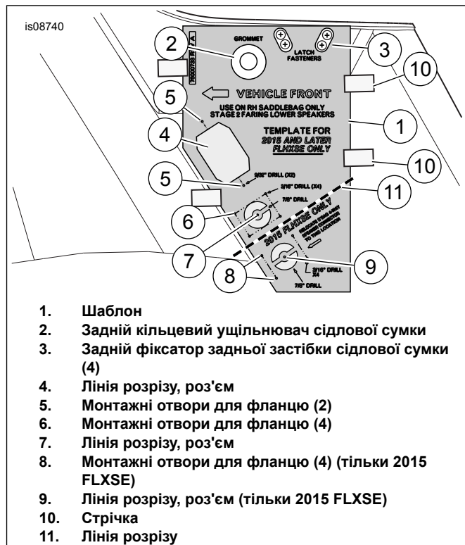
Малюнок 3. Правий розріз сидлової сумки та установка джгутів для свердлення
