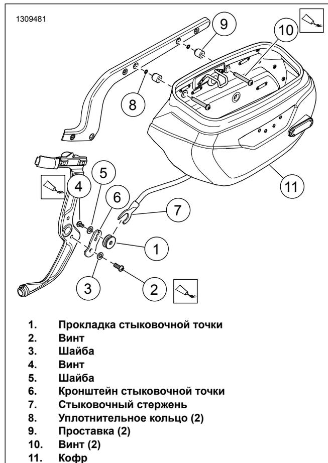
Рисунок 2. Монтаж кофра (слева)
