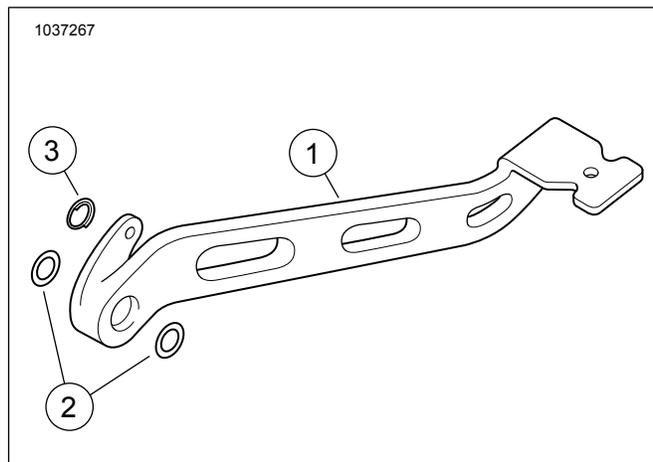
Рисунок 2. Комплекты рычага тормоза опоры для ног
