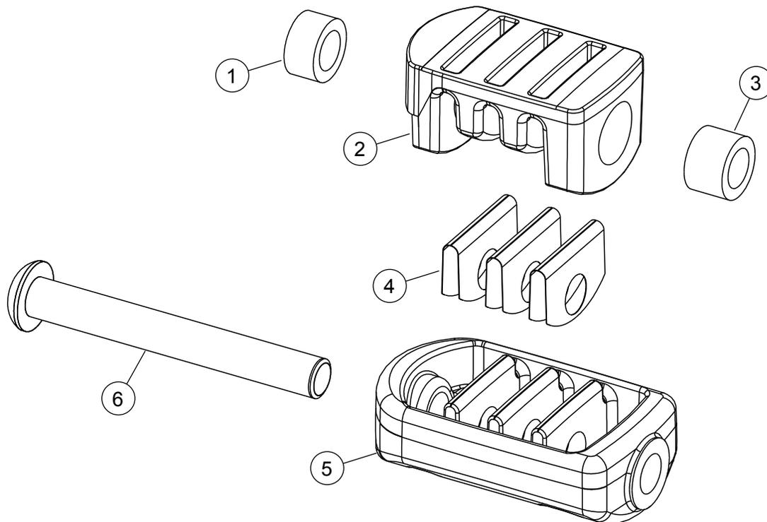
Figure 1. Pièces de rechange : Kit d'embout de sélecteur Streamliner
