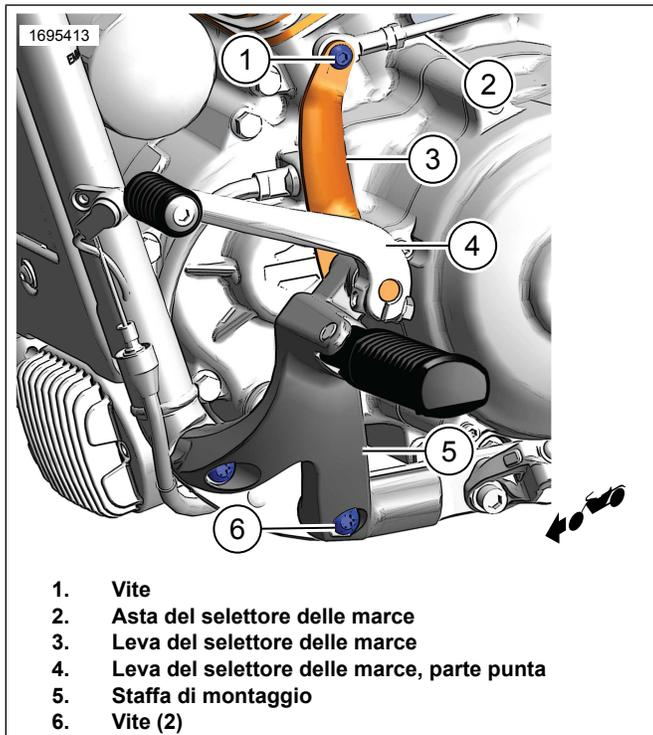
Figura 1. Sostegno del pedale
