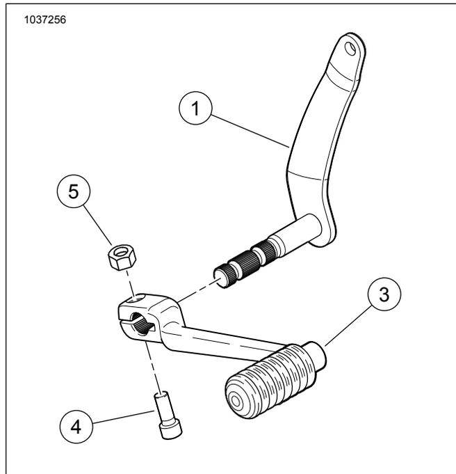
Figura 4. Kit della leva del selettore delle marce, tacco
