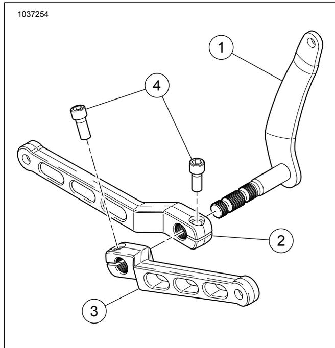
Figura 2. Kit della leva del selettore delle marce tacco/punta
