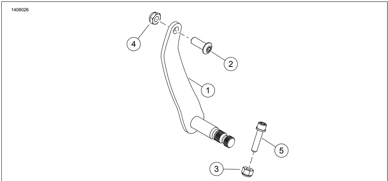
Figure 1. Contenu du kit : Éléments du dossier de conducteur
