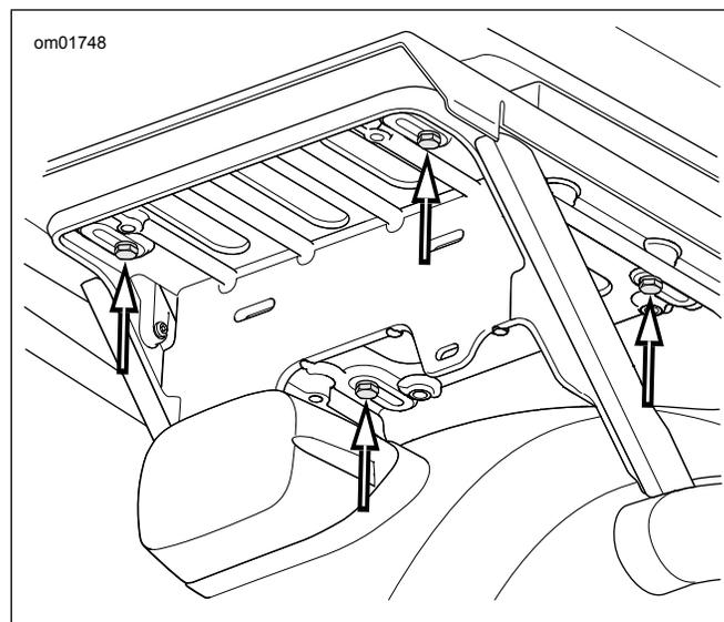
**Figura 4. Parafusos da braçadeira do Tour-Pak (APC/mo-
