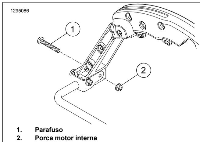
**Figura 6. Remoção do parafuso OE**
