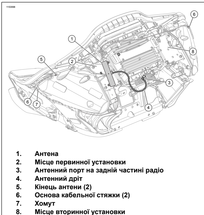
Малюнок 2. Підключення та прокладка антени
