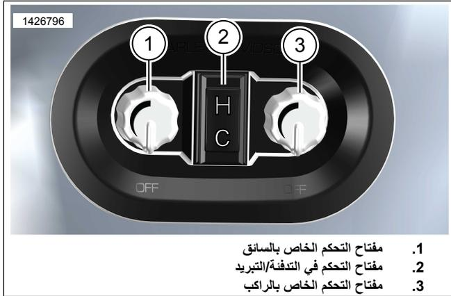
الشكل 6. مفاتيح التحكم في تدفئة/تبريد المقاعد
