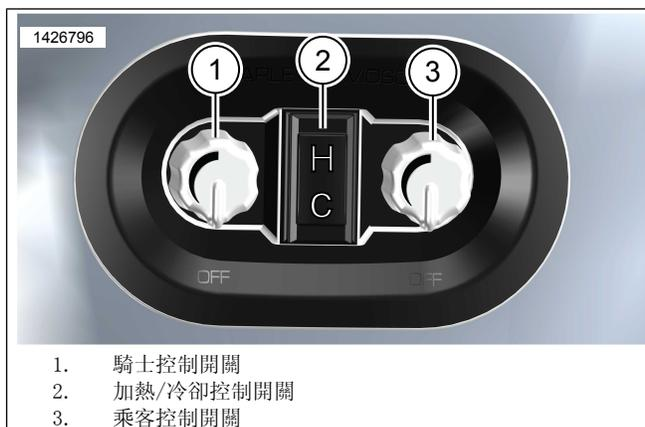
圖6。座椅加熱/冷卻控制開關
