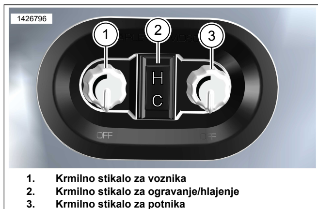
Slika 6. Krmilna stikala za ogrevanje/hlajenje sedeža
