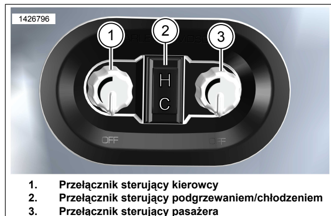
Rysunek 6. Przełączniki sterujące ogrzewaniem/chłodzeniem siedła
