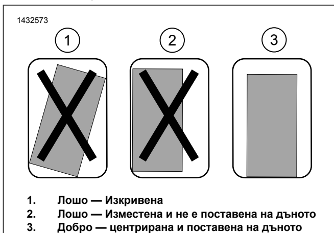
Фигура 4. Монтиране на монтажна скоба
