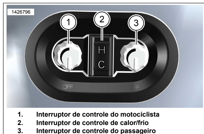
Figura 6. Interruptores de controle do aquecimento/refrigeração do assento
