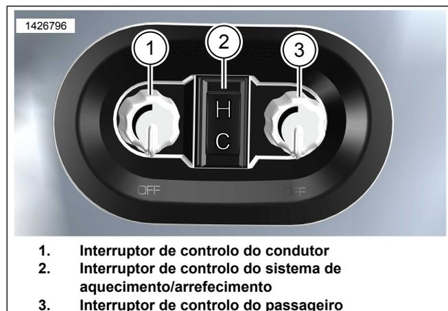
**Figura 6. Interruptores de Controlo do Sistema de Aquecimento/Arrefecimento do Assento**
