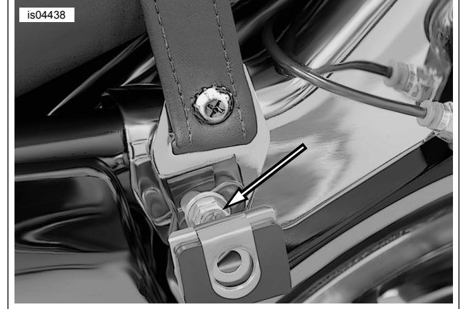
Şekil 1. Yolcu Kavrama Kemerinin Çıkarılması (Gösterilen 2008)
