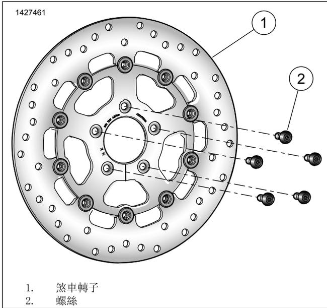
圖1。維修零件前煞車轉子(盤)工具包
