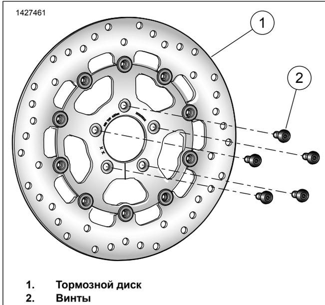
Рисунок 1. Запасные части: Комплект переднего тормозного диска
